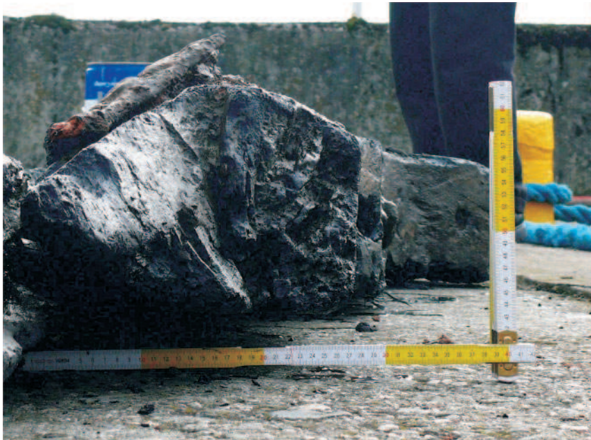
Ryc. 4. Kształt belki wewnętrznej. Romboidalny przekrój prawdopodobnie zastosowano w celu dopasowania schodzących się na tym elemencie klepek poszycia dolnych partii kadłuba, fot. A. Ostasz Fig. 4. The shape of the inner beam. The rhomboid cross-section was used probably to fit planks of the lower parts of the hull meeting on this element, photo A. Ostasz
