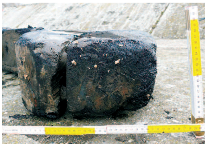
Ryc. 3. Widok na płaskie ścięcie stępki w miejscu, w którym powinna przechodzić w dalsze partie kadłuba, fot. A. Ostasz Fig. 3. A view of the flat cut of the keel in a place where it should extend towards further parts of the hull, photo A. Ostasz
