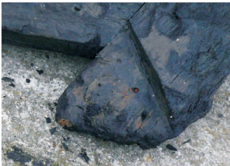
Ryc. 2. Widok na jedno z zakończeń fragmentu stępki (od strony prawej burty) z charakterystycznym trójkątnym wycięciem na montaż belki zewnętrznej, fot. A. Ostasz Fig. 2. A view of one of the ends of the keel fragment (from the starboard) with a distinctive, triangular cut for the installation of an external beam, photo A. Ostasz
