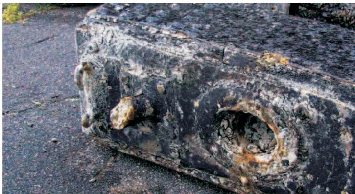
Ryc. 4. Widok na górne okucie sterownicy z pozostałością po flagsztoku i półkłuzą. Wewnątrz otworu widoczne przesunięcie okucia względem samego otworu, fot. A. Ostasz
